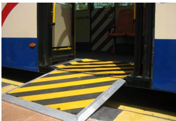
写真 2-5-9 超低床バスとバス停の接続
