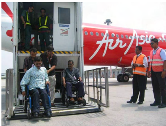
写真 2-5-13 リフト利用による機体への 乗り込み
