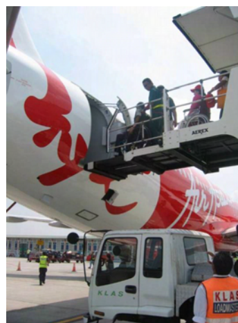
写真 2-5-14 リフトによる機体への 乗り込み
