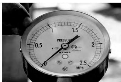
水栓のバルブくり圧力を上げる。1分間以上で観測する。
