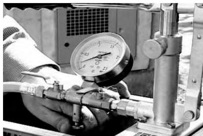
管路に水圧を付加し、一定時間予圧（管膨張による圧力低下を補うように加圧する）した後、管路を密閉し一定時間後の圧力を計測し、管の膨張による影響か漏水かを判定する。
