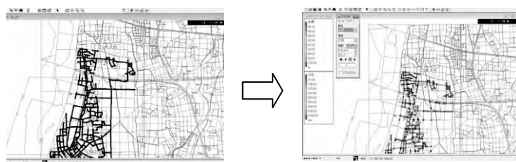
図 7-5 解析前管網（左図）と水圧解析による表示（右図）
