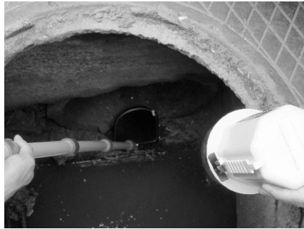
Nguồn: nhóm nghiên cứu JICA Hình 3.3.2 Khảo sát cống bằng gương
