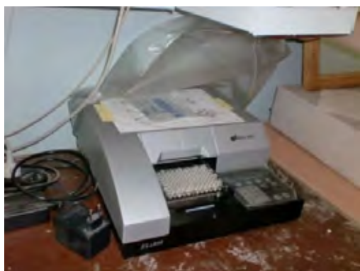
Фото 3-5 Приборы в лаборатории. Считыватель микроплат.
