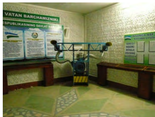
Фото 4-13 Разработанный институтом распылитель полезных насекомых
