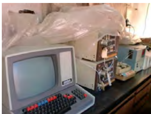
Фото 3-23 Аппаратная комната. Жидкостный хроматограф 1980г. выпуска
