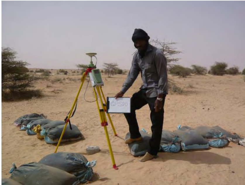
Figure 2.8 Observation GPS à un point (GPS20)
