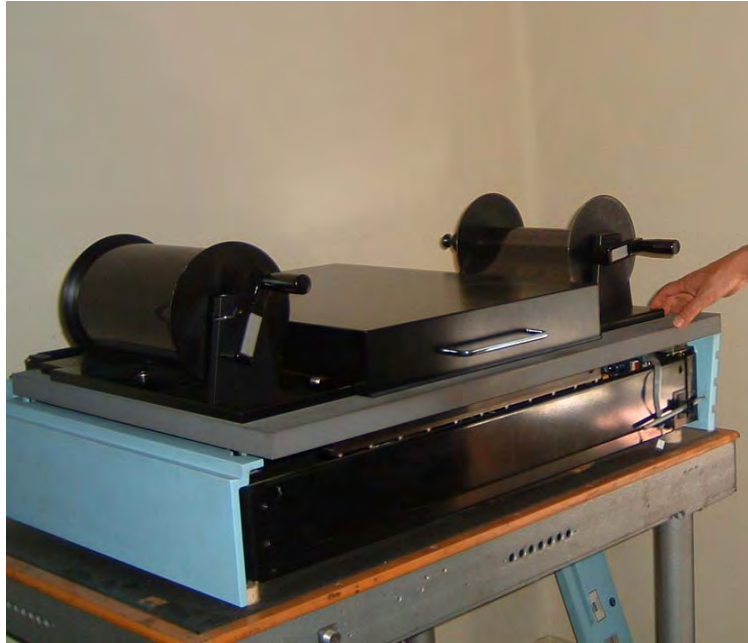
Figure 2.17 Scanning d'une bobine de film au moyen de "Vexcel Ultrascan 5000"
