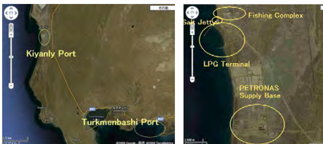
Рис. 2.1.40 Расположение порта Киянлы (слева) и размещение сооружений в порту (справа)
