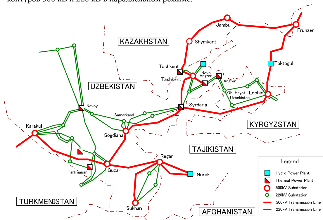
Рис. 1-1-3 Схема электроэнергетической сети Республики Узбекистан
