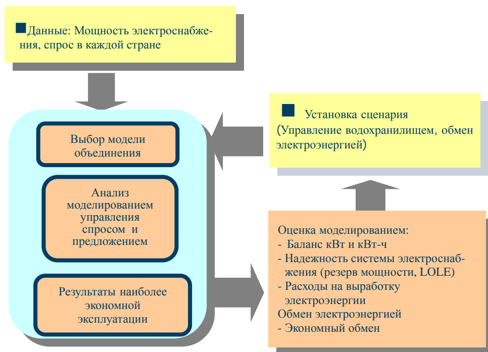
Рис. 3-7 Анализ моделированием с помощью программы PDPAT II
