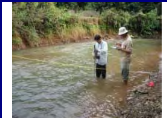
ກຳລັງວັດແທກຄວາມໄວຂອງກະແສນ້ຳ ດ້ວຍເຄື່ອງວັດແທກໃນໄລຍະຫ່າງກັນ 1 ແມັດ
