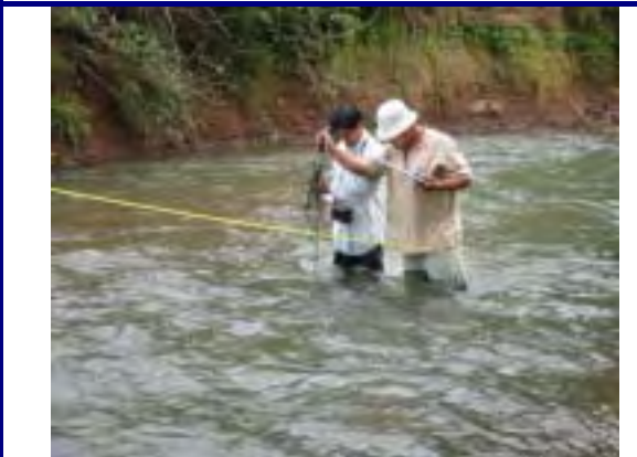
ກຳລັງວັດແທກຄວາມໄວຂອງກະແສນ້ຳ ດ້ວຍເຄື່ອງວັດແທກໃນໄລຍະຫ່າງກັນ 1 ແມັດ
