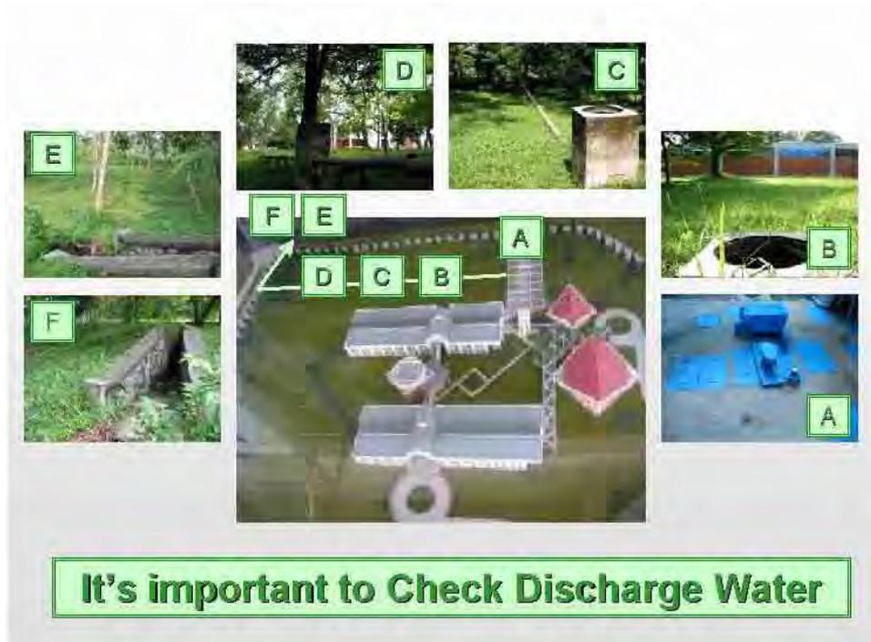
**Fig.4.1      Puntos de muestreo para el contralor de la calidad del agua residual**
