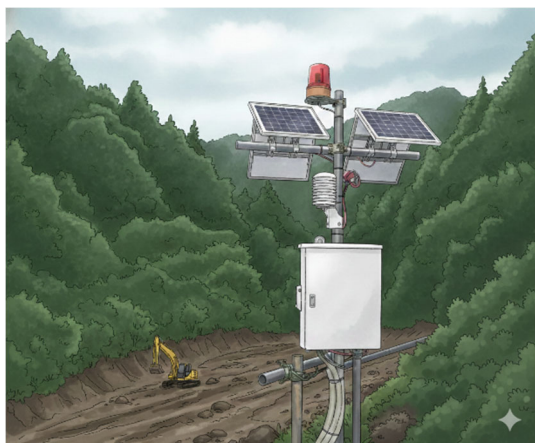
監視カメラ、雨量計、警報装置（サイレン、赤色灯など）等の設置状況（※Gemini で生成）
