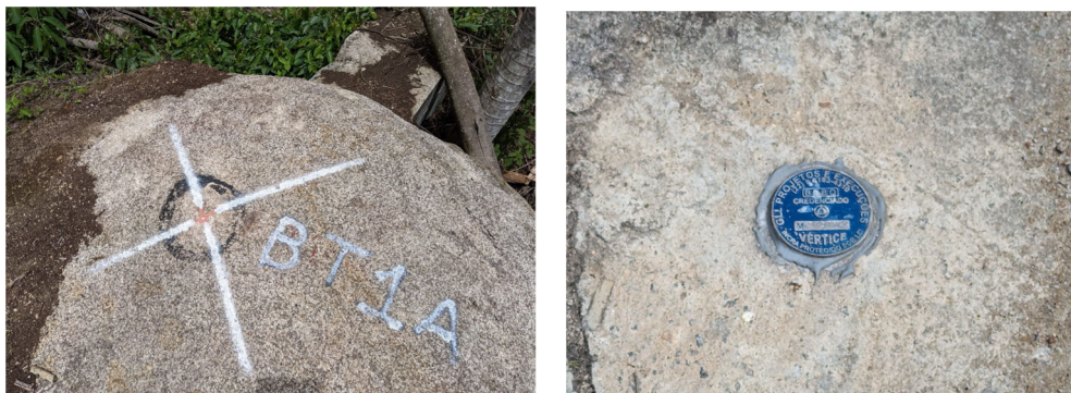
図 2.2.3 砂防堰堤計画地点周辺への測量杭設置
