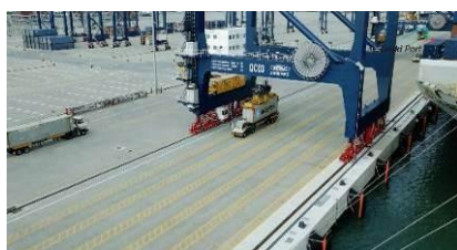
エプロン上のトレーラーへの積み下ろし
