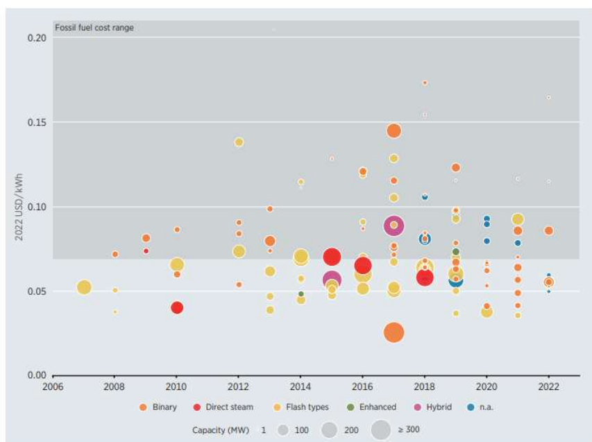
Figure 5-28 Технологи болон төслийн хэмжээгээр газрын гүний дулааны эрчим хүч үйлдвэрлэх зардал (LCOE).
