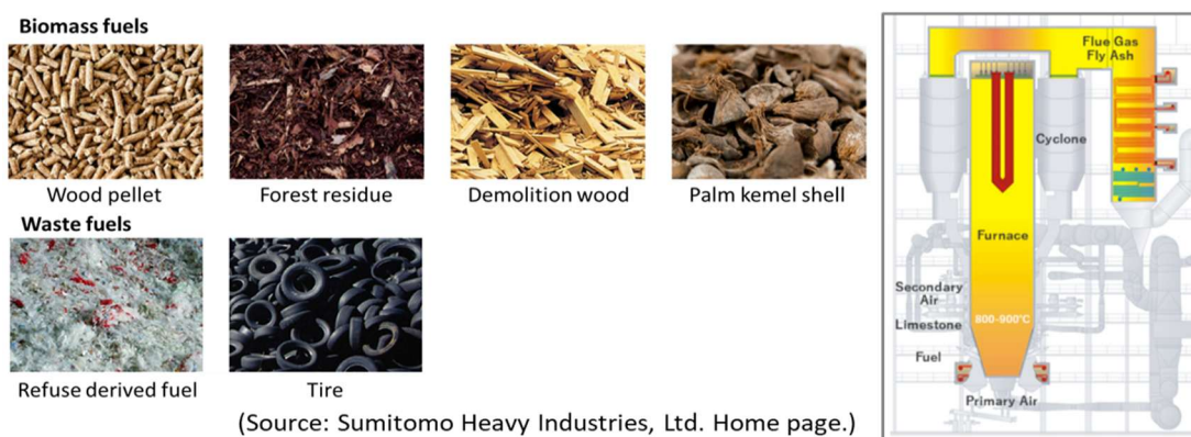
Figure 5-42 Sumitomo Heavy Industries CFB бойлер болон төрөл бүрийн түлш
