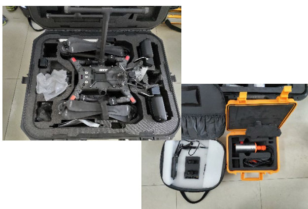
写真 2.4.3 ドローンと地上 Lidar 測量及びシングルビーム測深機材のセット
