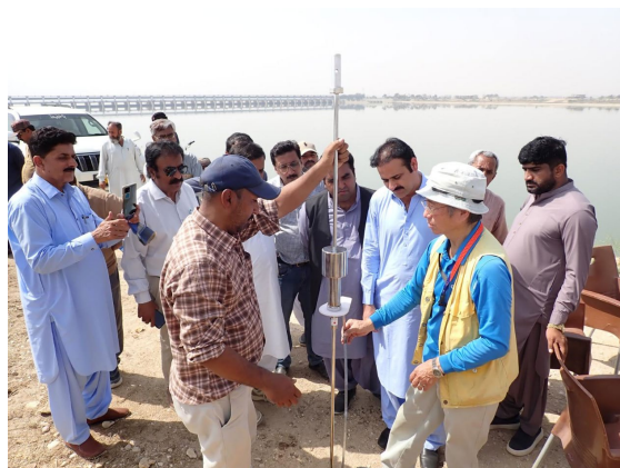
写真 2.4.18 簡易貫入試験機の計測風景 (Punjab 州)
