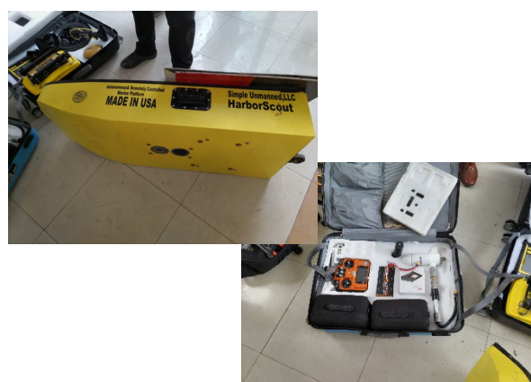
写真 2.4.4 水底の測量が可能なラジコンボート
