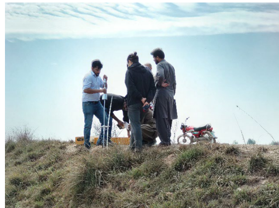
写真 2.4.11 簡易貫入試験機の計測風景 (Punjab 州)
