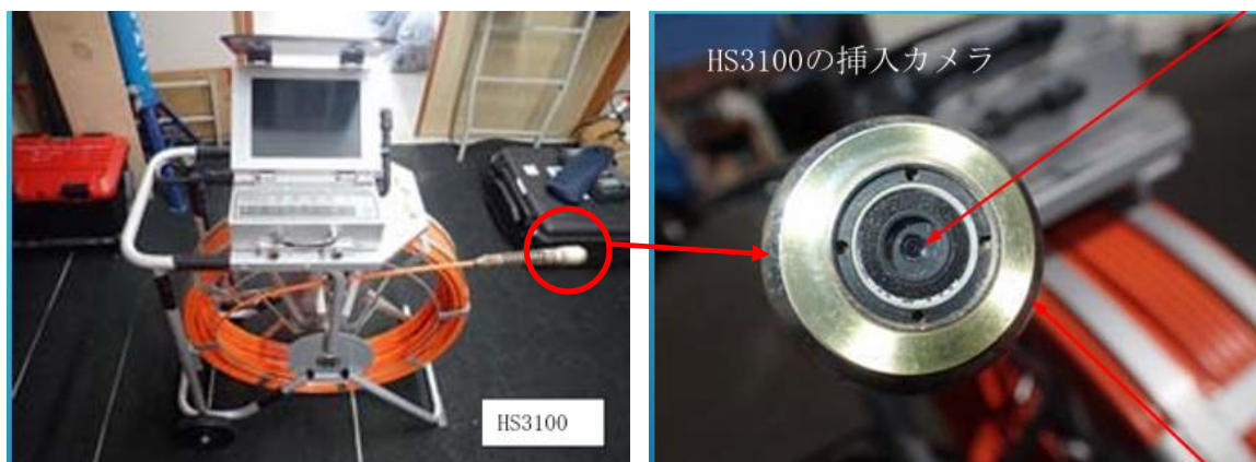
Figura 7 Monitoreo con camara CCD para sondeo
