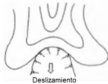
Figura 11 Ilustración de la cresta de un deslizamiento de tierra (según Watari y Kobashi, 1987)
