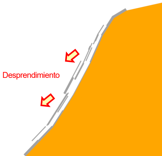
Figura 24 Imagen del esquema y fotografía de caso de estudio del desprendimiento
