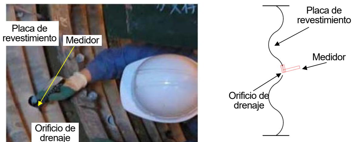
Figura 16 Situación de la medición del espesor restante de los materiales
