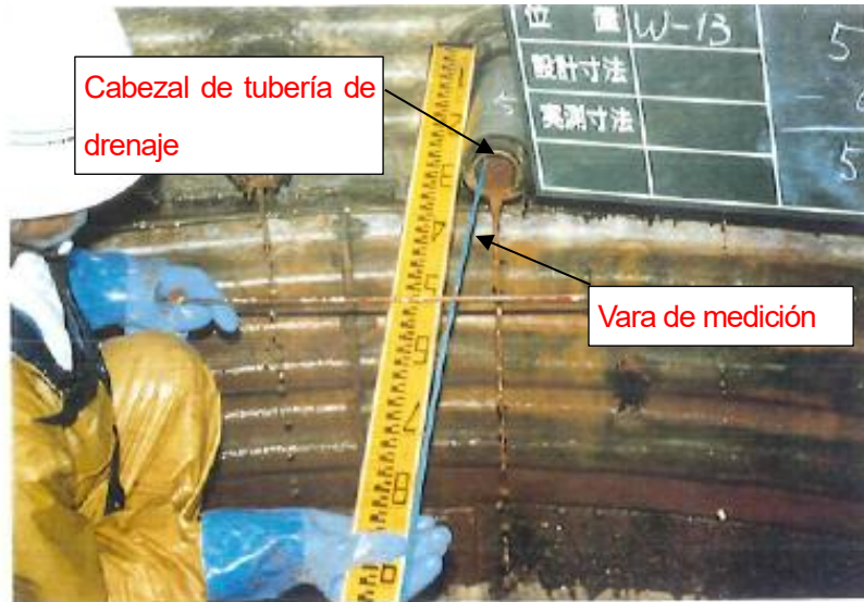
Figura 6 Situación de monitoreo (Caso de estudio de drenajes horizontales dentro de pozo de drenaje)
