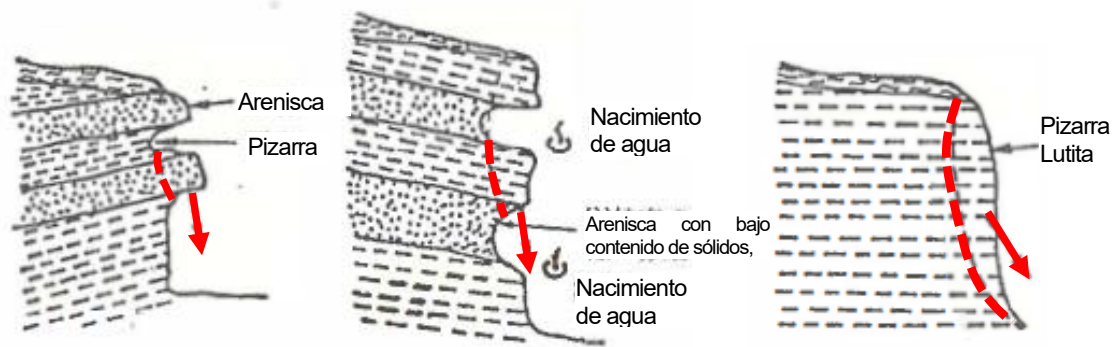
Figura 56 Diagrama de colapso
