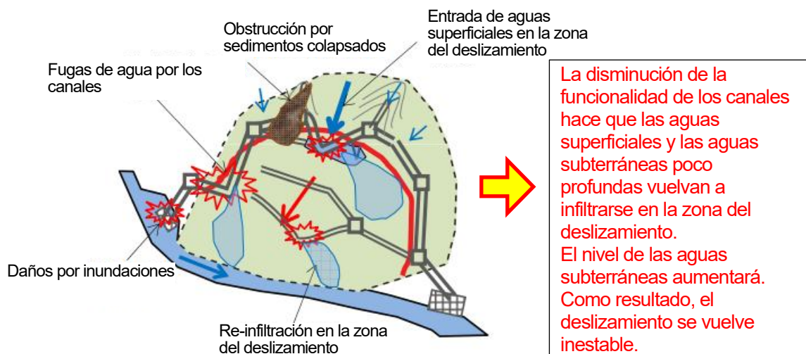
Figura 20 Impacto en la estabilidad del deslizamiento por la disminución de funcionalidad de los canales
