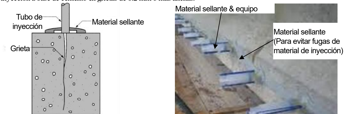
Figura 53 Esquema gráfico del método de inyección
