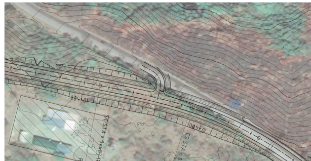
カンパラ側の既存道路との分岐点
