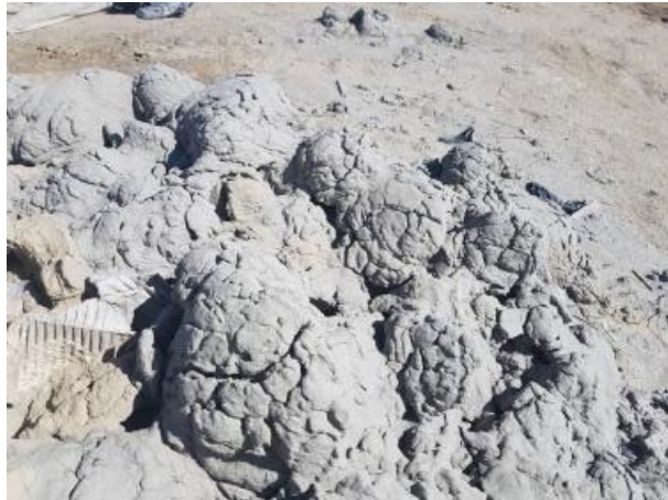
図 3.6.2 泥灰岩の崩れかけた様子 [M. Akdim, 2022]
