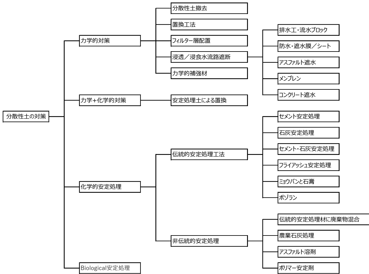
図 2.2.19 分散性土の対策工法
