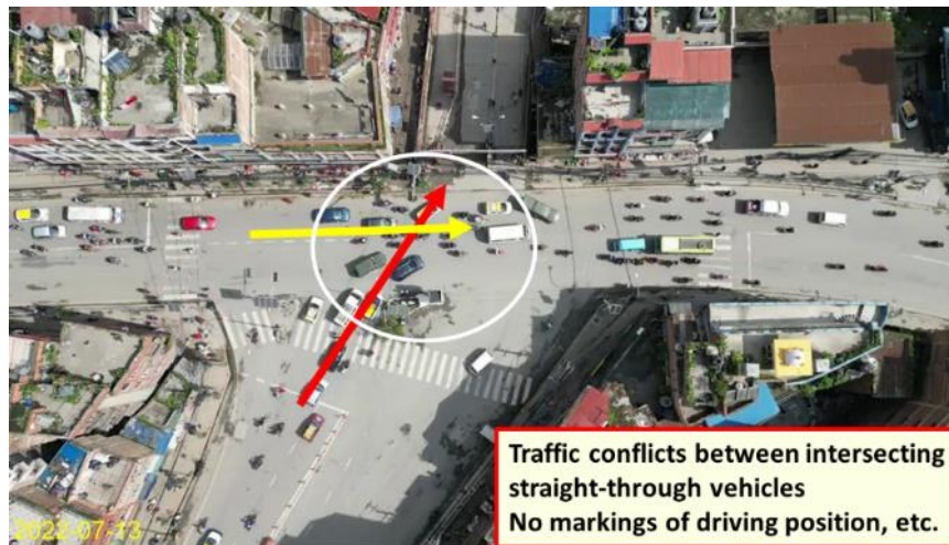
図 5.2：ドローン撮影によるビデオ解析の例（交差する直進車同士の衝突・未遂）
