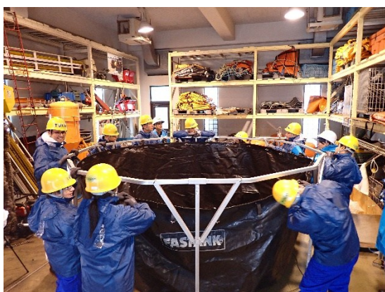
写真 43 実習：一時貯油タンクの組立 (2025 年 5 月 30 日 5 日目)
