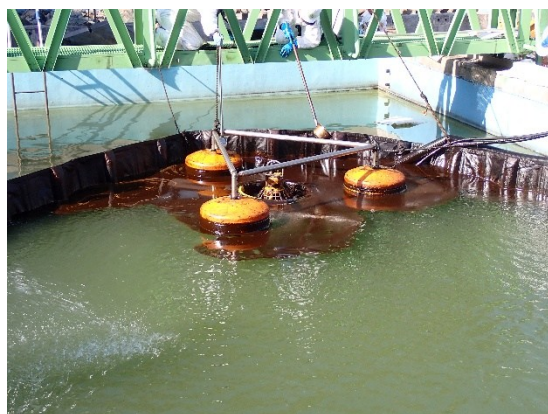
写真 25 実習：回収装置で浮遊油を回収 （2025 年 5 月 28 日 3 日目）
