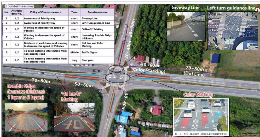
図 5.3.5 2022 年度 第 2 回 RSA により決定された交差点の交通安全対策(By-pass No.3)
