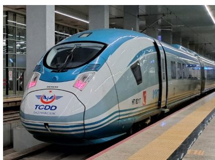
図 1-8 Velaro をベースとした高速鉄道車両 (TCDD HT80000)
