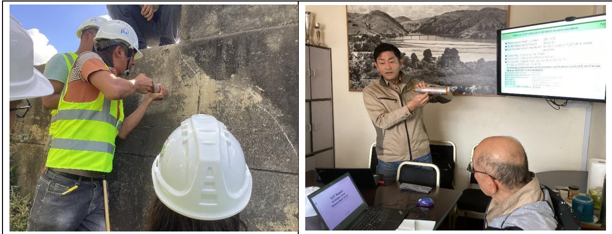
Figure 2-81 Formation sur le tas pour l'utilisation du marteau Schmidt
