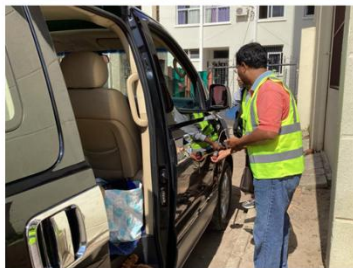
Mesure de la distance entre essieux et position de l'appareil (Measurement of wheel base and sensor distance)
