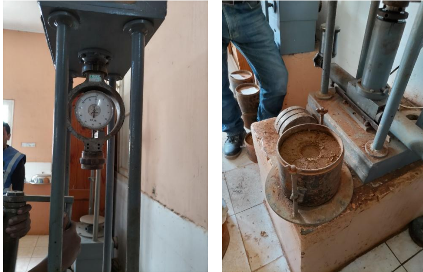
Figure 2-27 Testeur CBR et moule (photo prise le 12 mai 2023)
