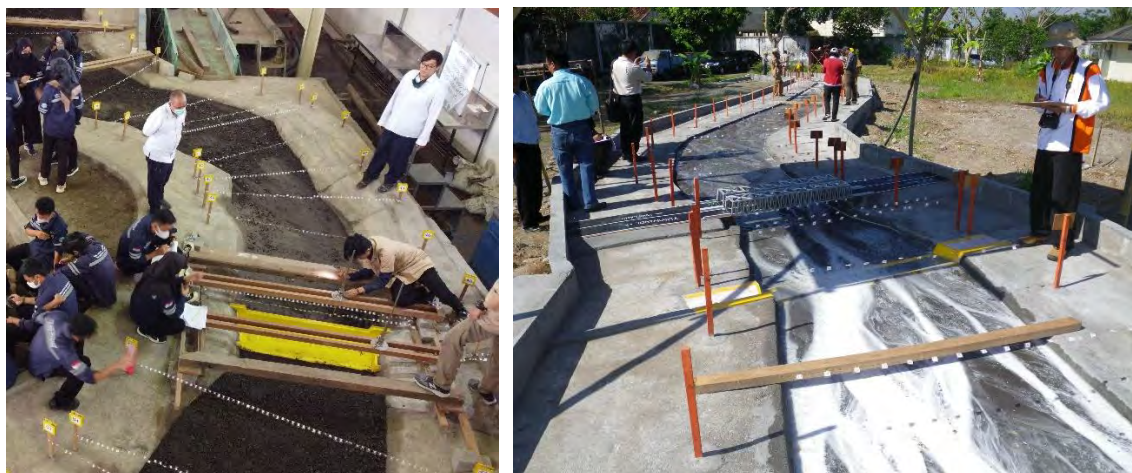
(曲流部の砂防堰堤の堆砂過程確認, 2021年) (土石流を想定した放水路の機能検証, 2011年)
