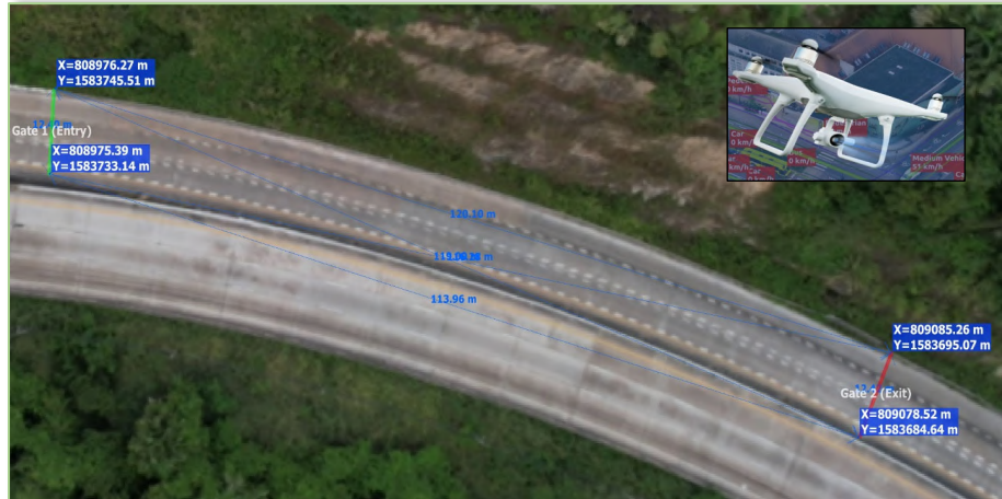
図 5.3.79 AI 画像解析による車両の走行軌跡
