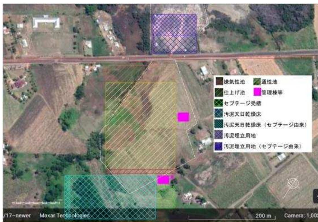
図 5-3.19 Rakiraki 下水処理場：安定化池法
