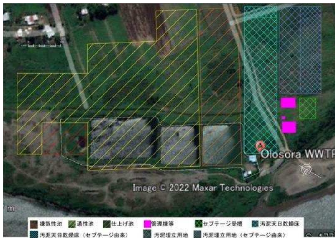
図 5-3.22 Olosara 下水処理場 (Sigatoka)：安定化池法
