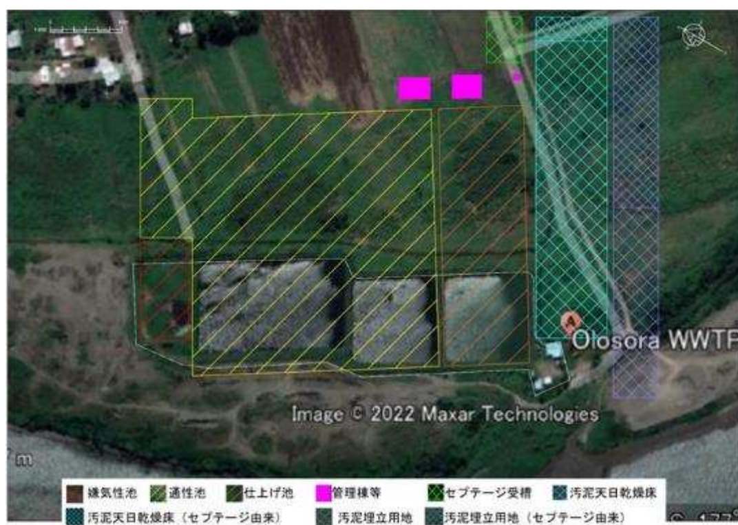
図 5-3.23 Olosara 下水処理場 (Sigatoka)：AL 法
