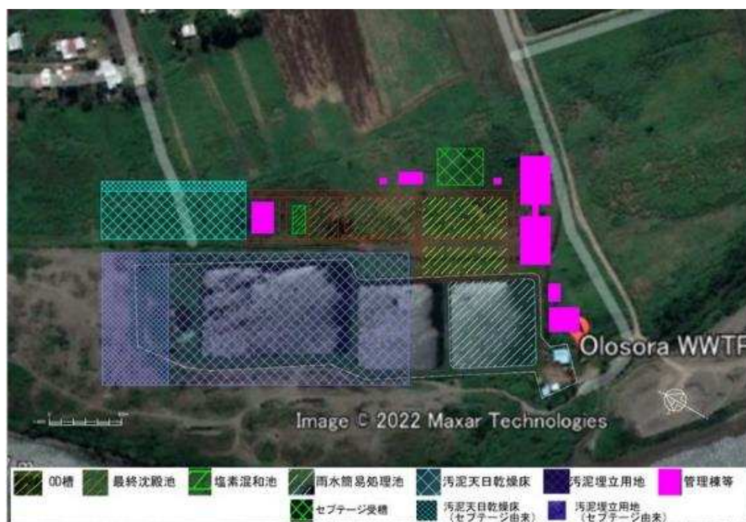
図 5-3.24 Olosara 下水処理場 (Sigatoka)：OD 法
