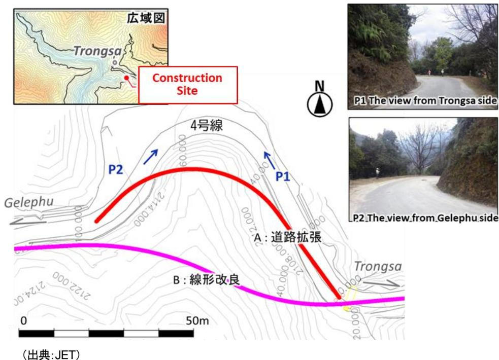
図 3.4-6 成果3 施工サイト位置図および現況写真
