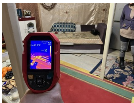
ゲル室内の温度分布（12月） 床暖房のため床面は非常に暖かい（赤）。一方で壁面は温度が低いことが分かる（青）
