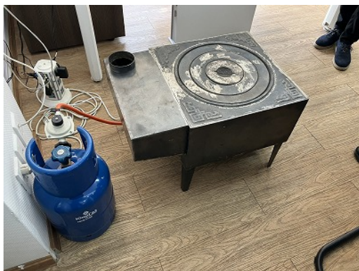
LP ガス式ゲルストーブ 伝統的の石炭ゲルストーブを改良。現状ではガス消費量が多く、燃効率の改善が必要
