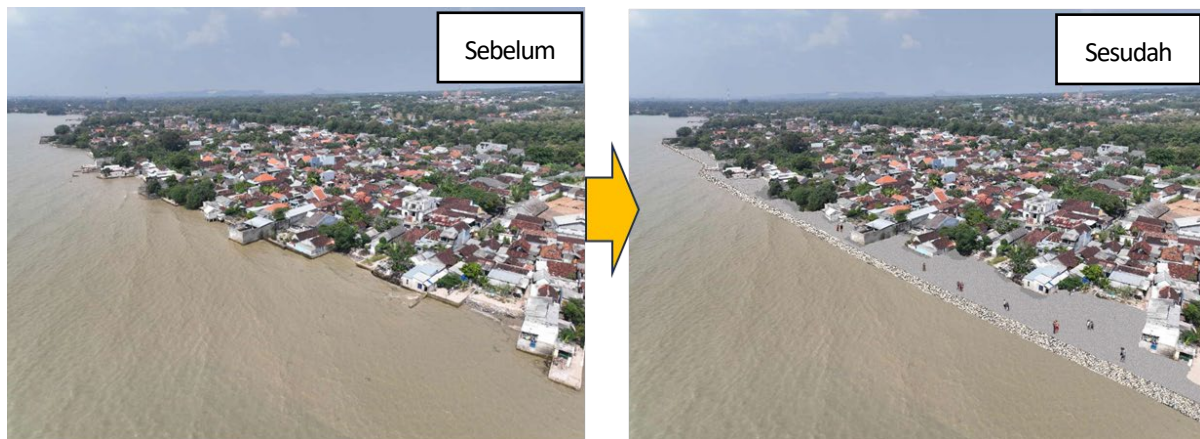
Gambar 4.5 Ilustrasi sebelum dan sesudah implementasi revetmen tipe-2 (T-c)
