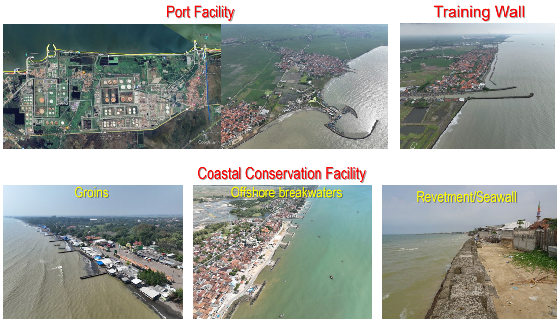
Gambar 7.3.3 Contoh fasilitas buatan sebagai batasan bagian ( section )
