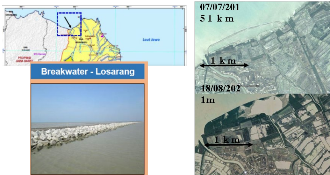
Gambar 2.7.9 Fasilitas Pesisir yang Menggabungkan Breakwater Lepas Pantai dan Bakau di Indramayu
