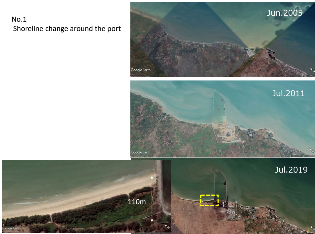
Gambar 12.2.7 Perubahan garis pantai di sekitar breakwater dari pelabuhan (No.1)
