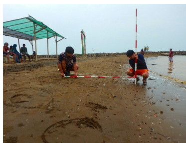
Offshore slope : 1/80 Foreshore slope : 1/10 Berm height : 0.8m
