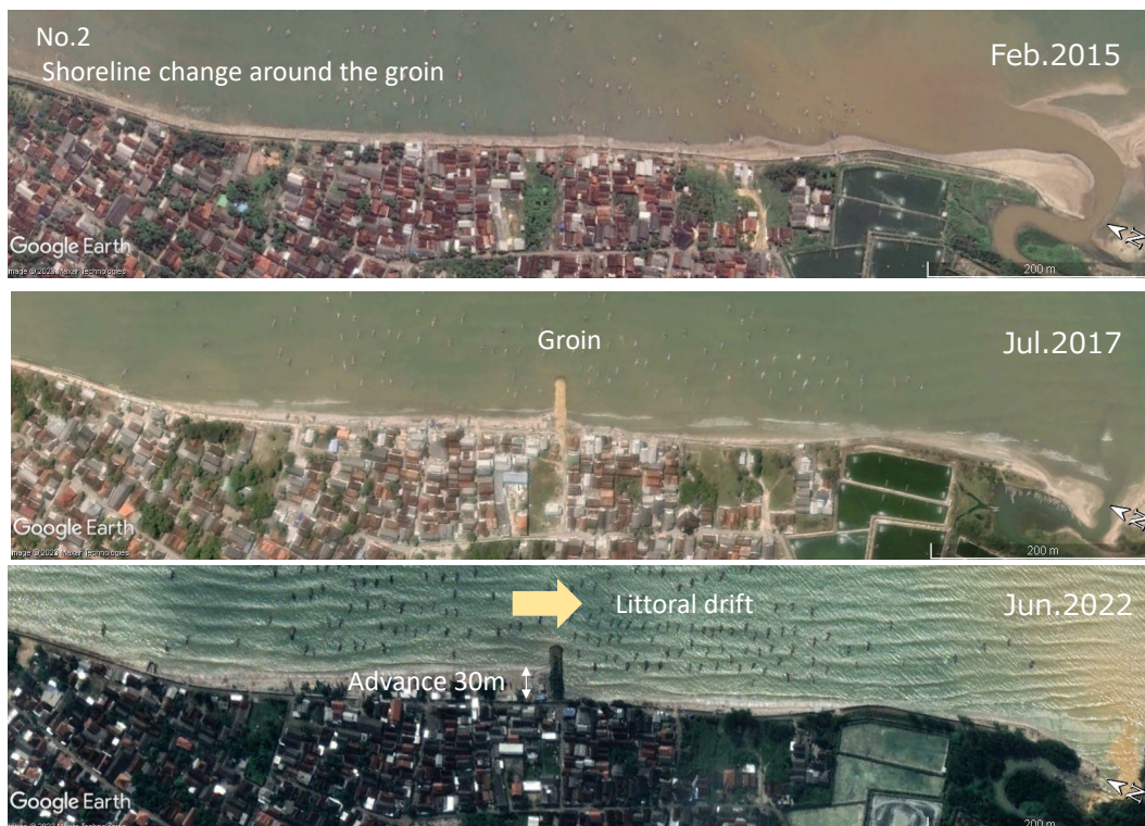
Gambar 12.2.8 Perubahan garis pantai di sekitar breakwater dari groin (No.2)
