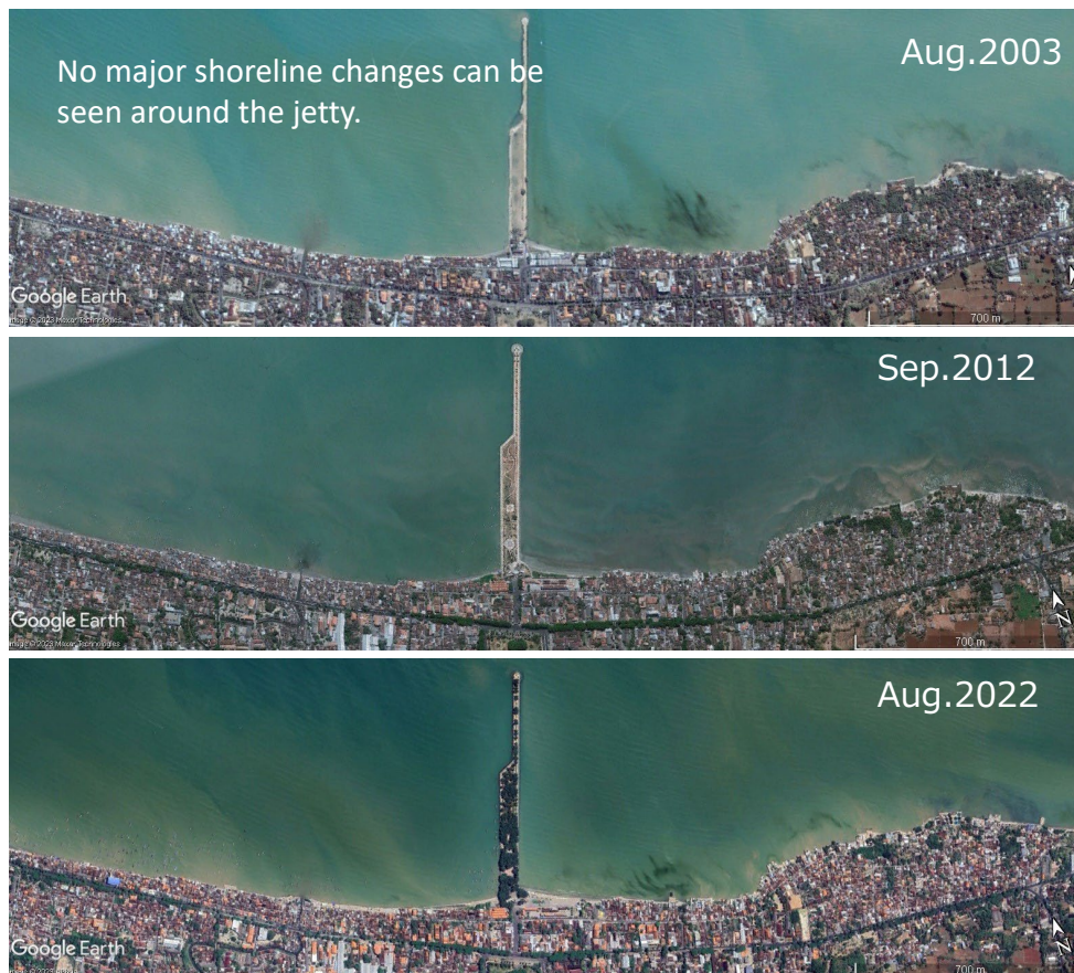
Gambar 12.2.13 Perubahan garis pantai di sekitar jetty (No.5)
