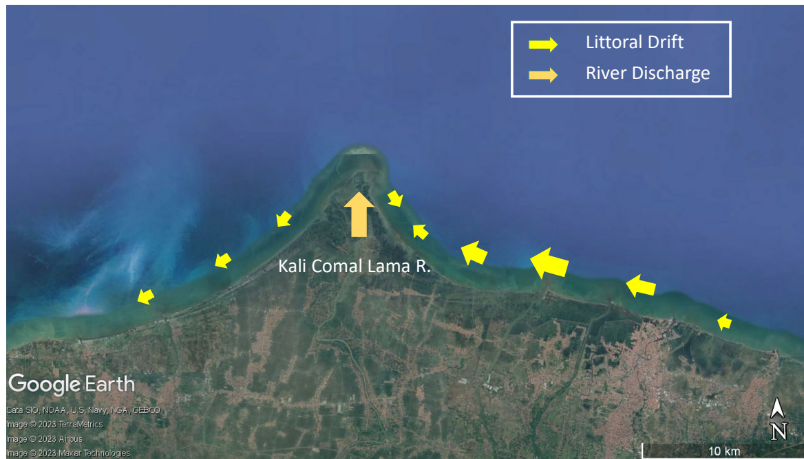
Gambar 6.1.30 Arah dominan littoral drift di Pemalang-Pekalongan
