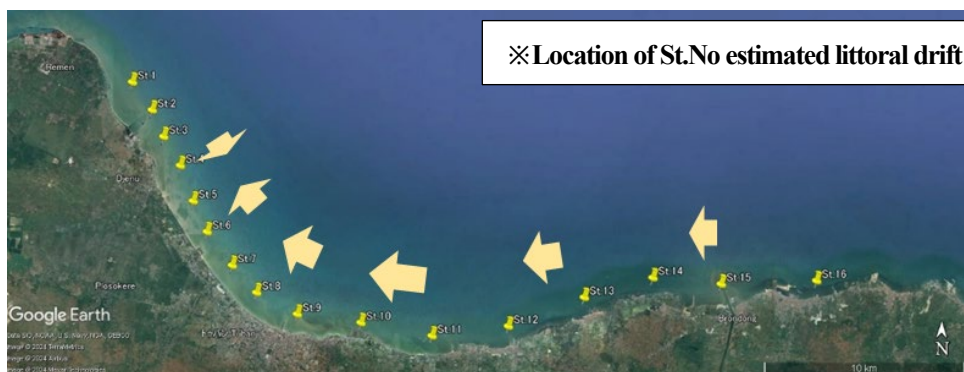
Gambar 12.2.18 Estimasi Pergeseran Sedimen yang Dominan
