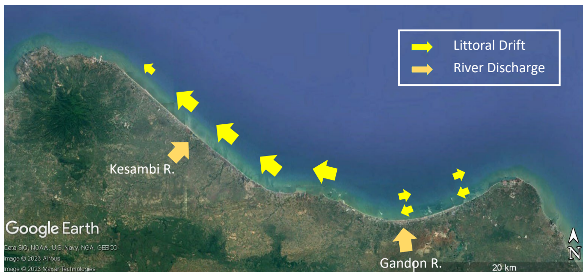
Gambar 6.139 Arah dominan littoral drift di Rembang-Tuban
