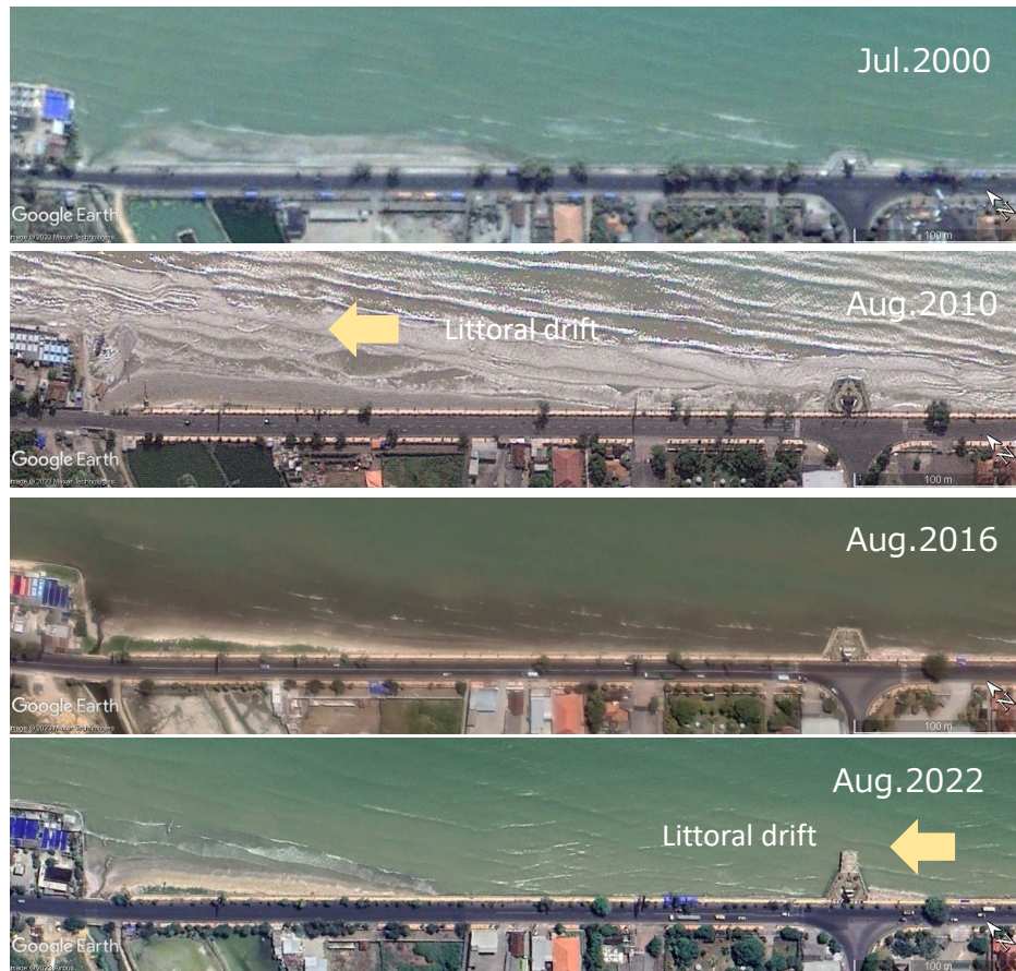
Gambar 12.2.11 Perubahan garis pantai di sekitar lahan reklamasi dan groin (No.4-a)
