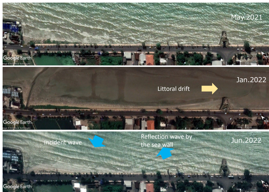
Gambar 12.2.12 Perubahan garis pantai di sekitar lahan reklamasi dan groin (No.4-b)
