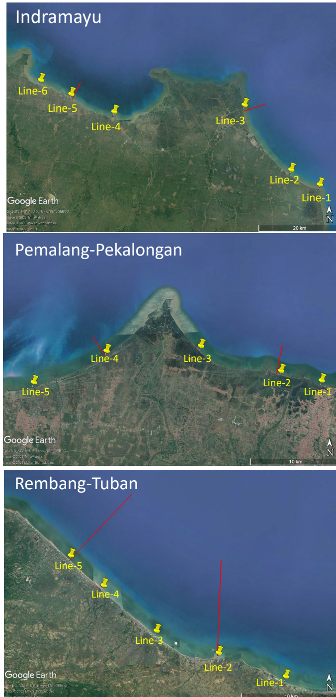
Gambar 3.1.2 Garis survei tiga lokasi tinjauan (Kuning: Survei topografi, merah: survei batimetri)
