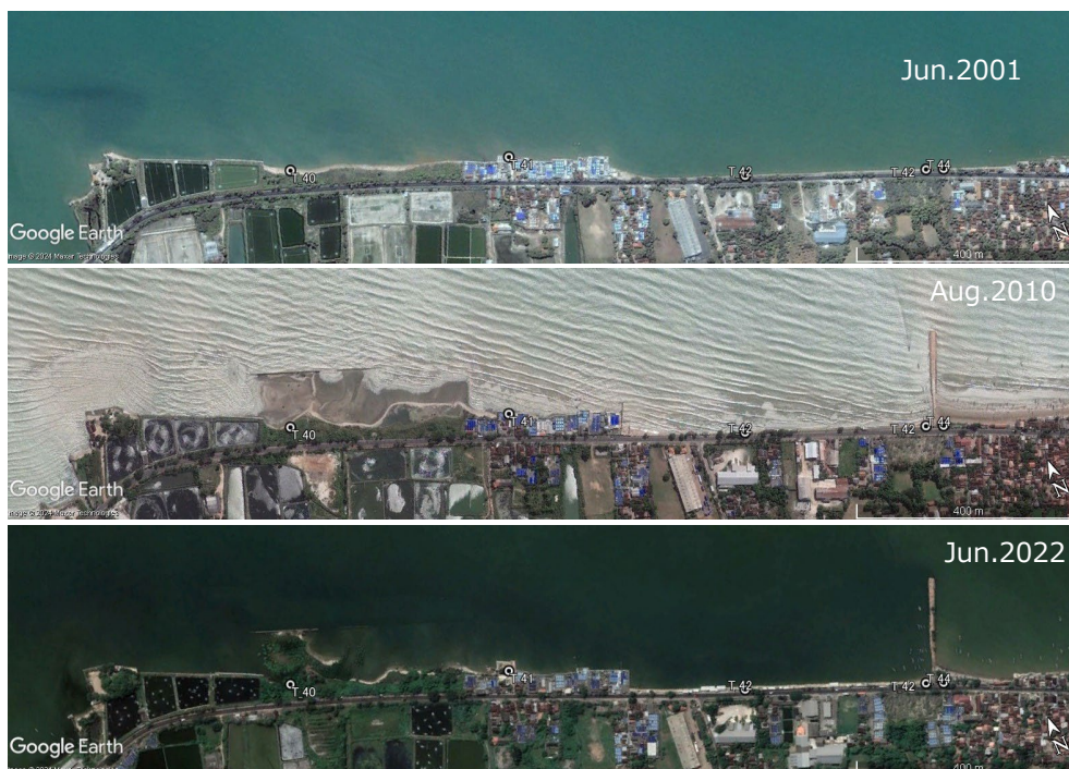
Gambar 12.2.14 Perubahan garis pantai di sekitar breakwater lepas pantai dan jetty (No.6)
