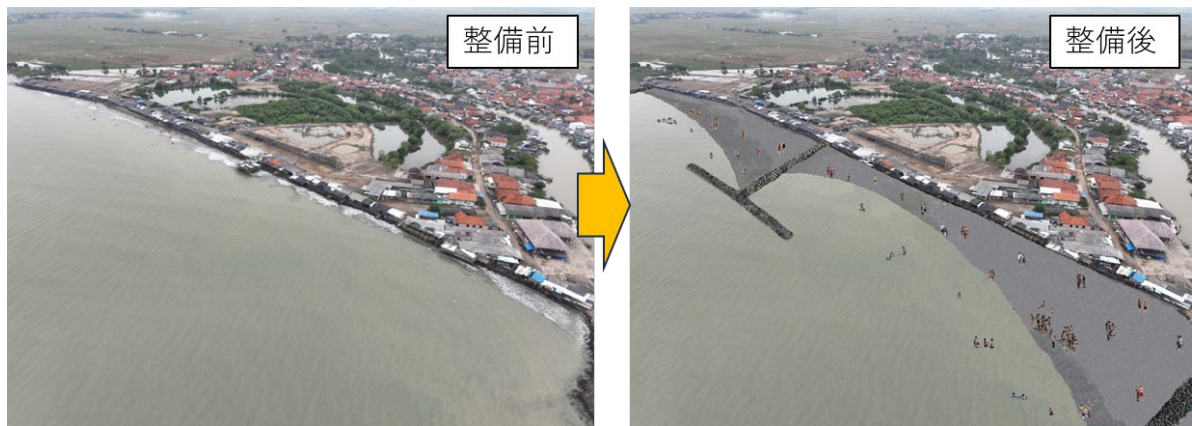
図 4.2 養浜とヘッドランドの整備前後のイメージ (Area-I, S-1a)
