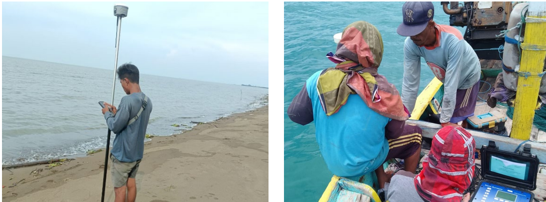
図 3.1.3 作業状況写真（左：海岸測量、右：深淺測量）
