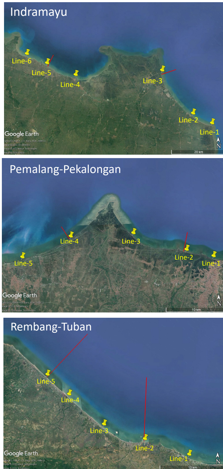
図 3.1.2 調査対象3エリアの測量位置 (黄色点：海岸測量、赤色線：深浅測量)
