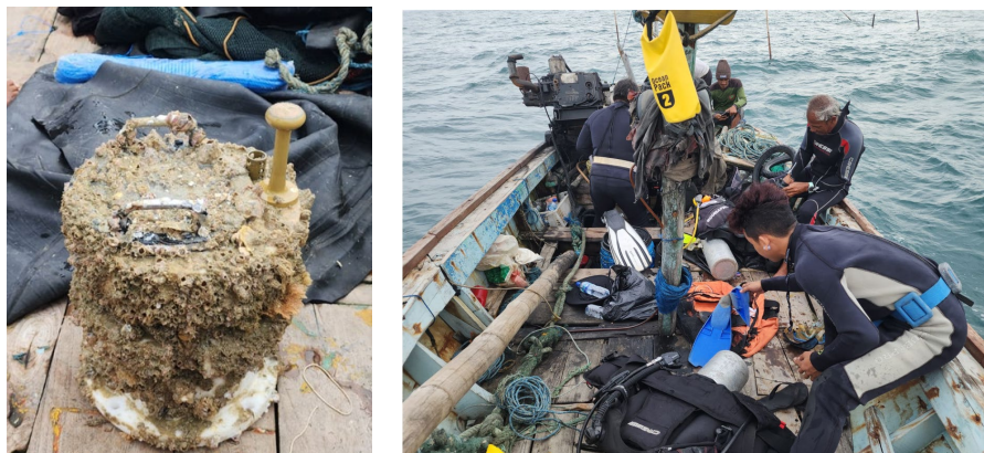
図 3.2.2 撤去後の波浪観測機器および現地調査写真
