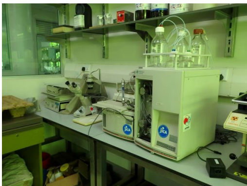
写真 11 伝統的医療センターに設置されている高速液体クロマトグラフィー（HPLC）装置。採取した植物の分析など、伝統医薬品の研究を行っている。
