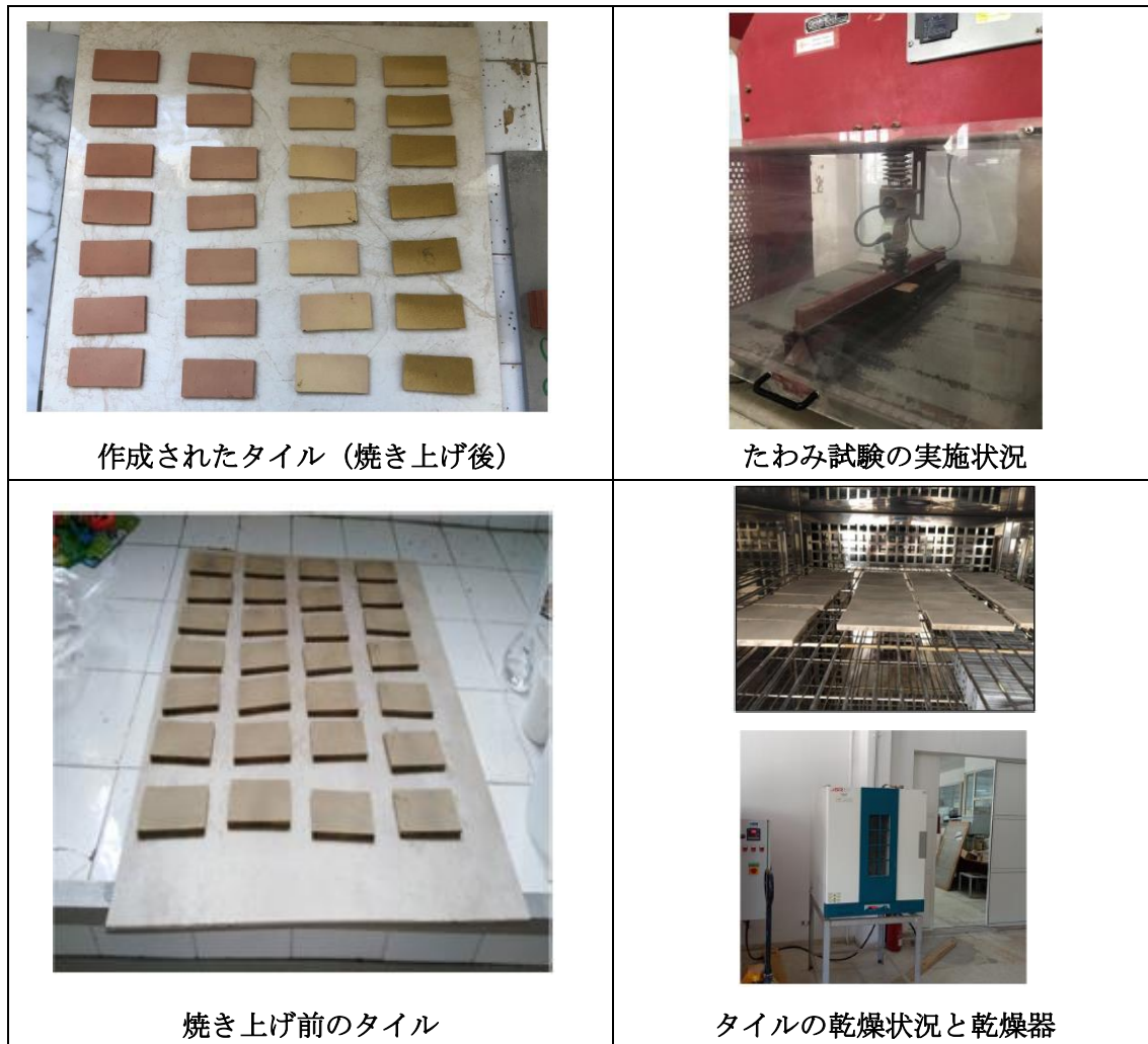
図 7-44 タイルの製作試験状況
