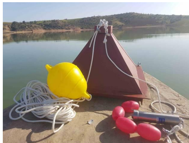
図 5-35 貯水池内への濁度計の設置器材
