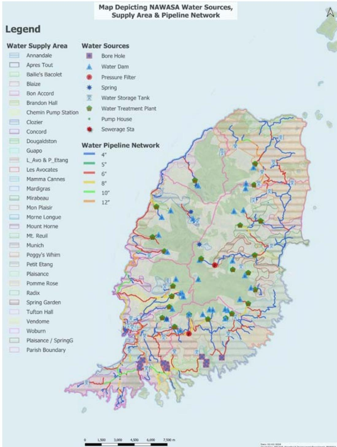
図 8-9 NAWASA の水源、水道施設および給水区域の位置図
