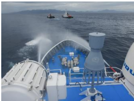
タグボート 2 隻による油処理剤散布に続く PCG 巡視船による航走・放水拡散
