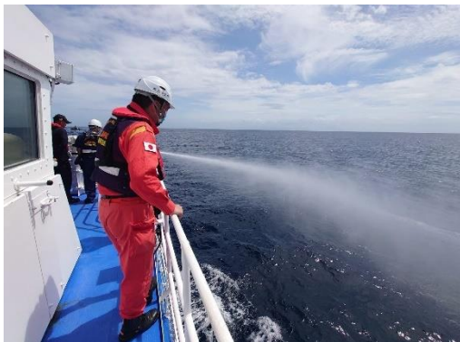
放水銃による油の拡散方法の指導
