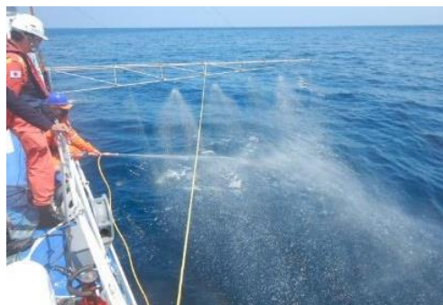
油処理剤の適正散布圧力
