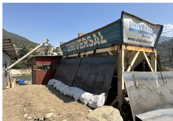
図 4.41 移動式の生コンクリート・プラント（GOIプロジェクト） 218
