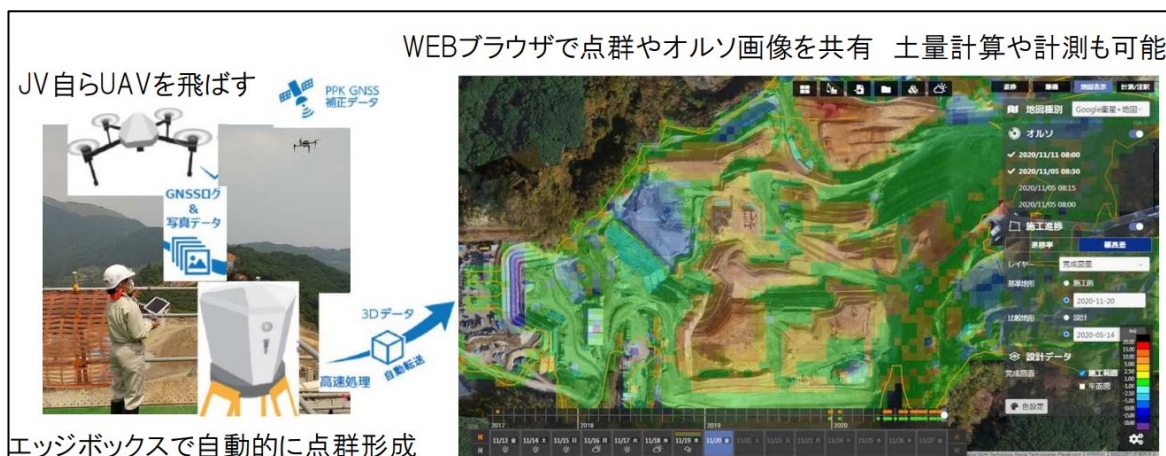
図 7.37 ドローンによる工事状況の WEB 共有状況
