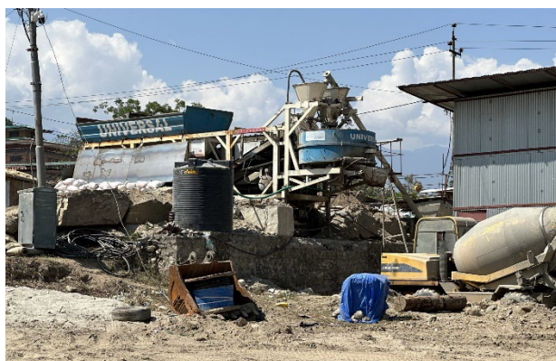
図 4.41 移動式の生コンクリート・プラント（GOIプロジェクト） 218
