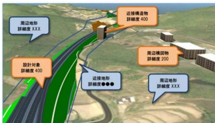
図 7.39 構造物ごとのモデル詳細度の設定状況の一例
