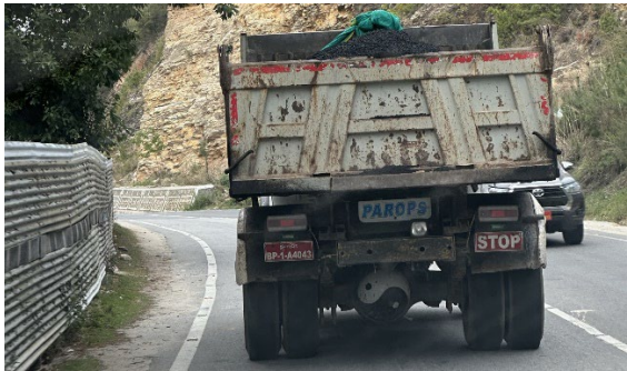
図 4.32 加熱アスファルト混合物を運搬するトラック 185
