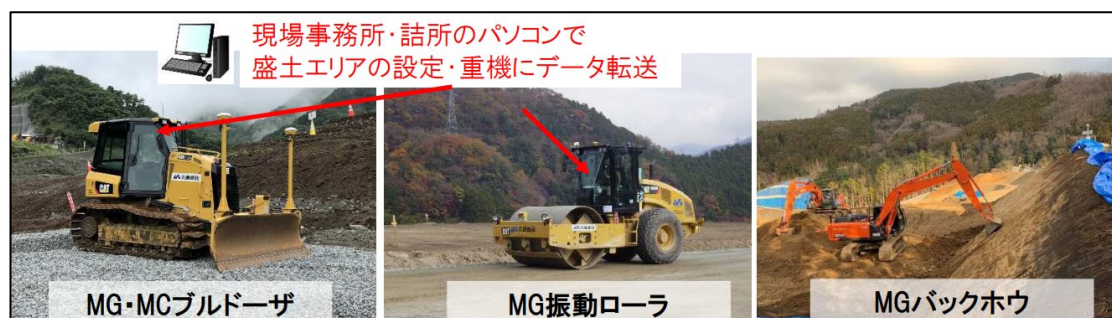
図 7.36 GNSS 搭載 ICT 建機の一例
