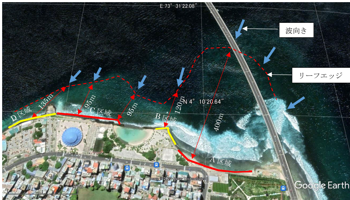
図 D-1-7. リーフエッジから護岸前面までの距離と区域分け図（出典：調査団）
