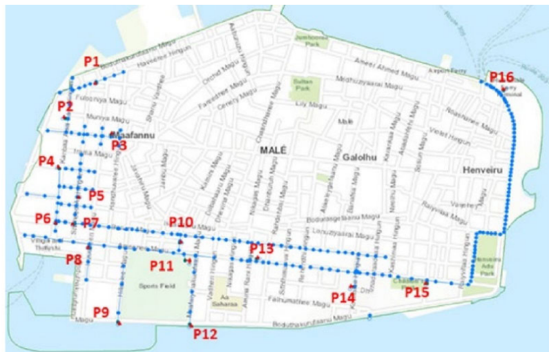
図.S-2. 雨水排水ポンプの位置図（Ameenee Magu道路改良工事完了後）
