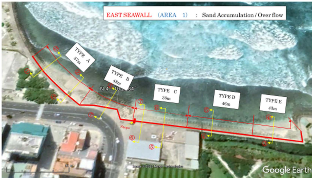
図 2-2-49 マレ島南東部の護岸補修工事区間 A-E
