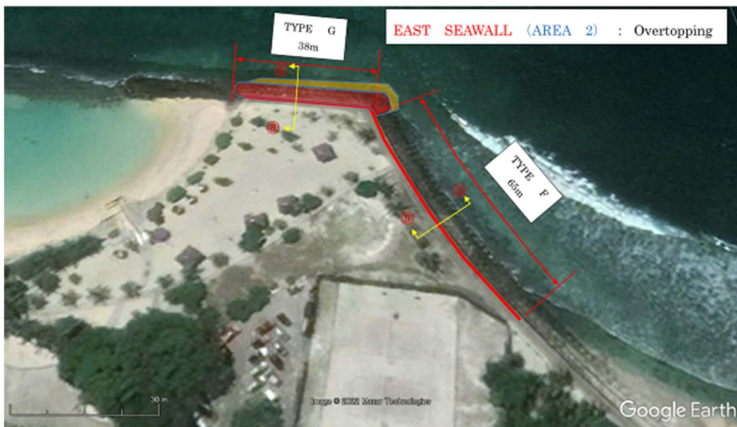
図 2-2-50 マレ島南東部の護岸補修工事区間 F-G
