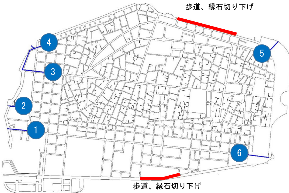
図 1-4-1 表面排水施設および排水管の位置
