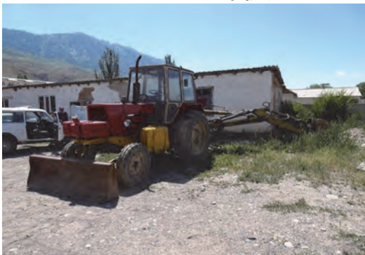
写 11 トラクターにエクスカベータをアタッ チメント ナリン州事務所
