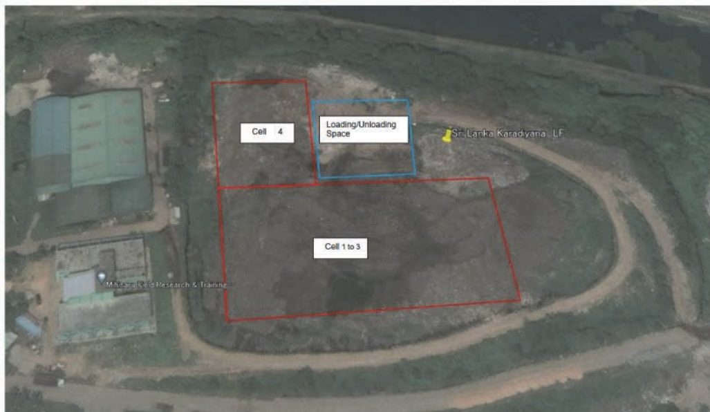
図 4-39 Site A のセルの配置計画
