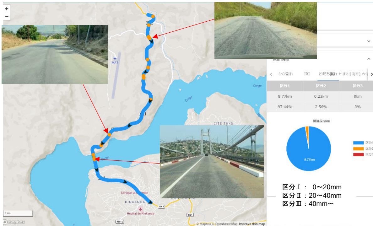
図 3.2.40 わだち掘れ深さ【上り線】
