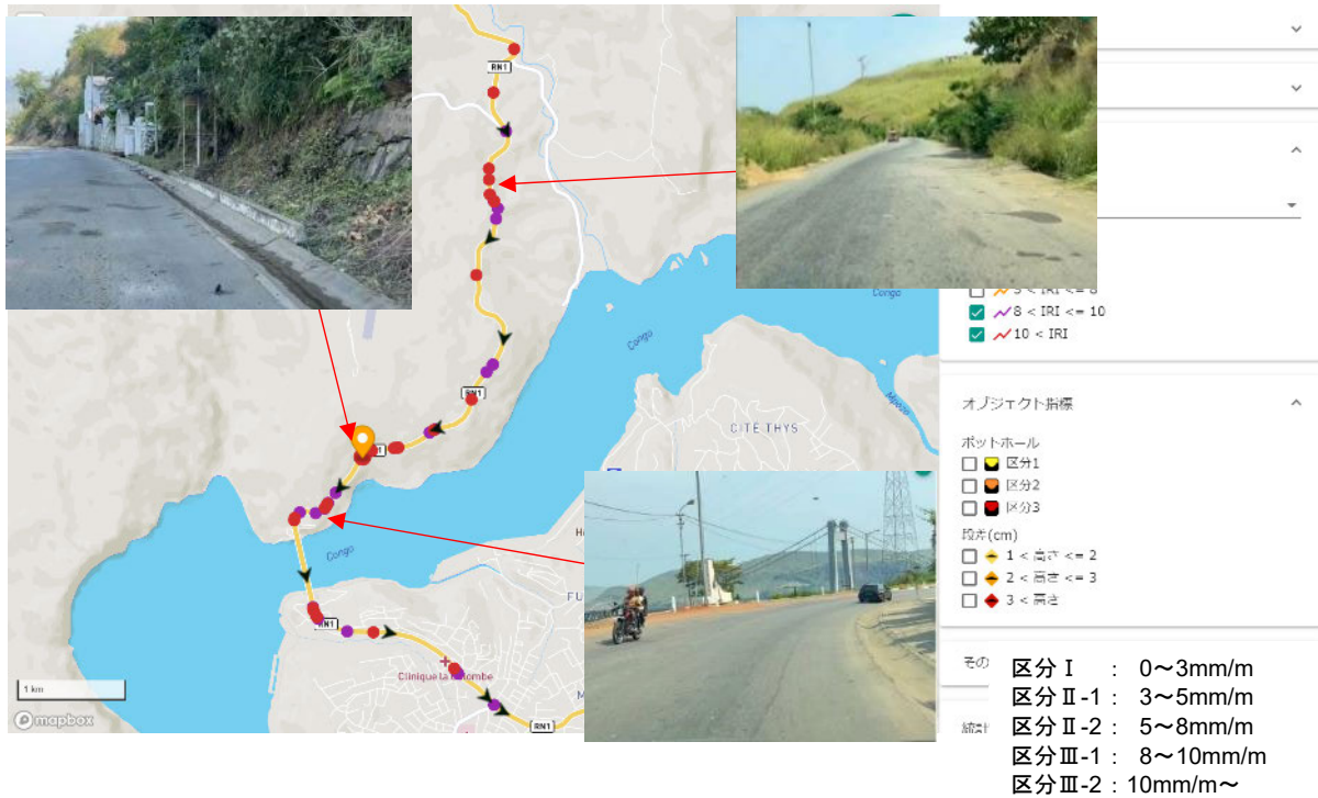
図 3.2.42 IRI（平坦性）（IRI>8mm/m の地点）【上り線】
