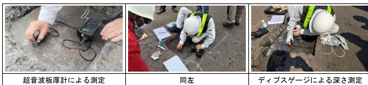
図 3.2.9 鋼床版板厚測定調査状況
