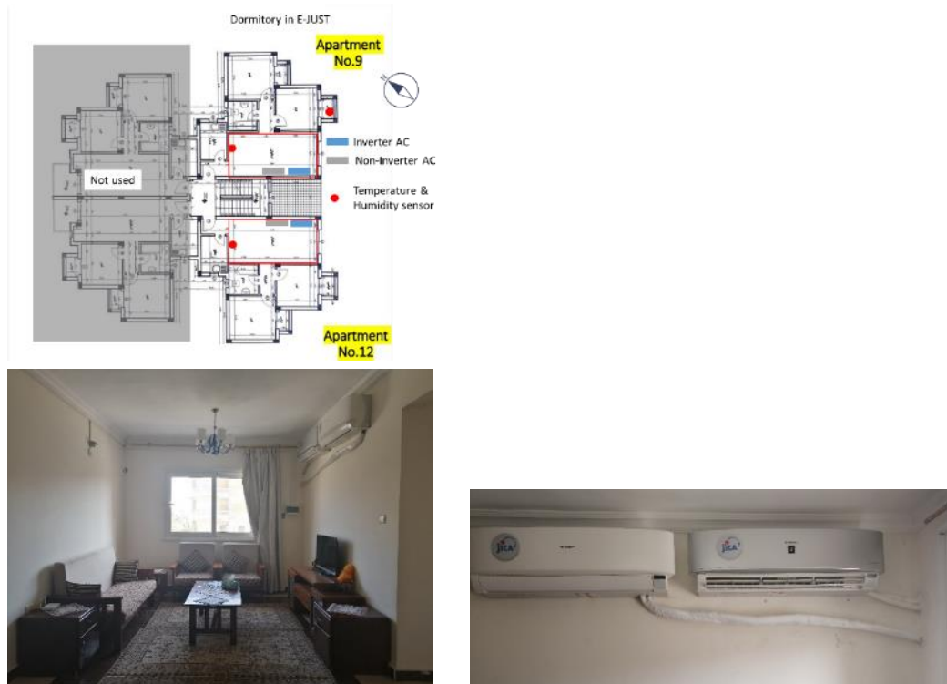
図 3-12：試験場所およびインバータエアコンとノンインバータエアコンの設置状況
