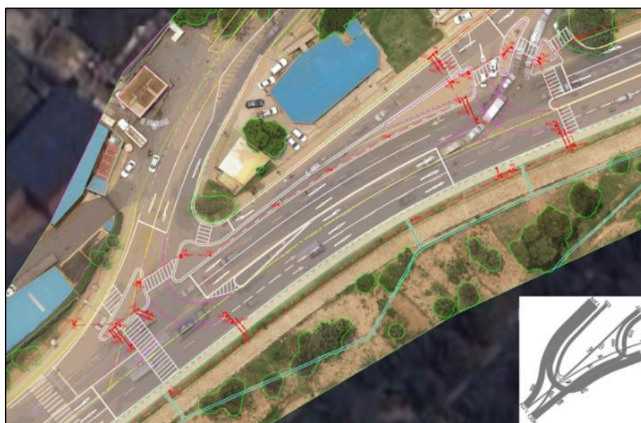
図 3.8 Kinamba 交差点の改良計画図（選定案）
