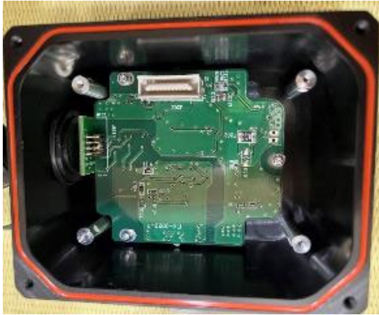
図 2.4.5 IT 震度計のセンサーの電源基盤②
