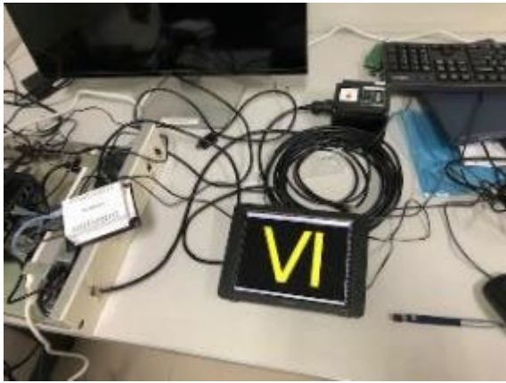
7. IT 震度計モニター表示動作確認状況 (HDMI) (マニラ PHIVOLCS 本部)
