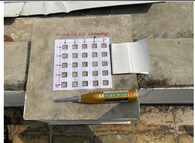
クルネガラ教育病院 産科病棟屋上のコンクリート強度測定状況(1/2)
