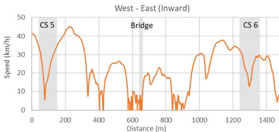
図 3.5.9 交差点及びボトルネック部における旅行速度の変化 (IS 5~IS 6)
