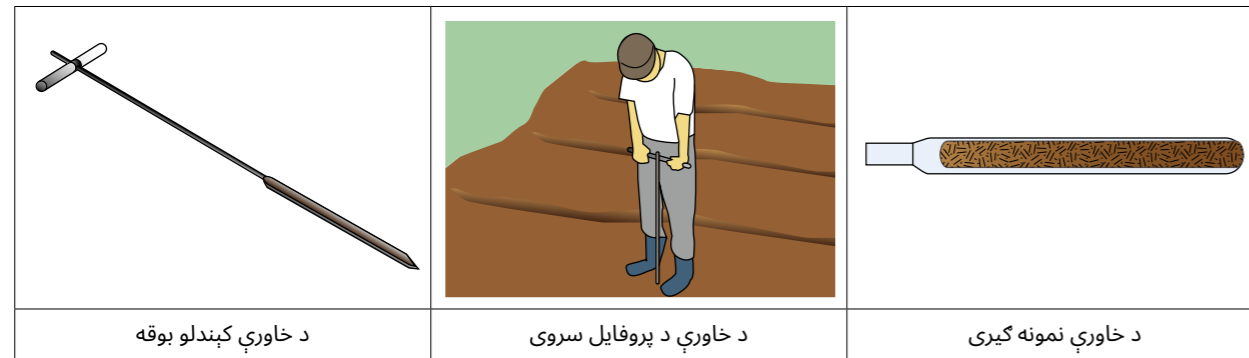
8.9 شکل : د خاورې کېندلو بوقی پواسطه د پروفایل سروی 12
