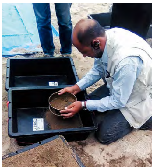
3.18 شکل : د سښد د تل يا بستر موادو سروې 2
