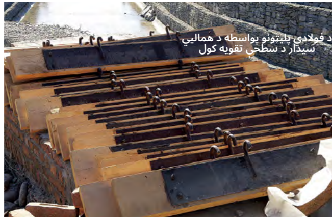
1.2.1 شکل: د هماليې سیدار تقويه شوي کنترولونکې تختي
