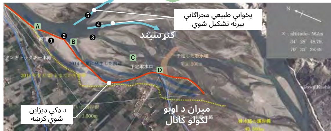
4 شکل: په میران اوبه نیونکې دروازه کې د سیند د پشته رژیدنه او د حل لاره 4)
